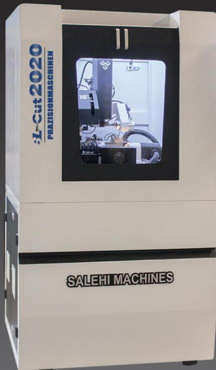
دستگاه تمام اتوماتیک تراش گوی CNC ، مدل 2020 ، دارای ۱۲ محور سرورو موتور می باشد که تحت شبکه کنترل می شود. این دستگاه بر روی انواع گوی های کروی قابلیت اجرا دارد و همچنین زمینه های بسیار دقیقی روی گوی اجرا می کند که تمامی خطوط روی گوی بصورت برنامه ریزی شده و دقیق سر جای خود قرار می گیرد.
